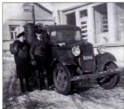
BB m. Ford vuosimallia 1934, polttoaineena koivupilkkeet ja voiteluaineena tervaskannoista suodatettua tervaöljyä. Kuljettaja Olavi Tartia vaimonsa kanssa. Purolan maisemat taustana.
